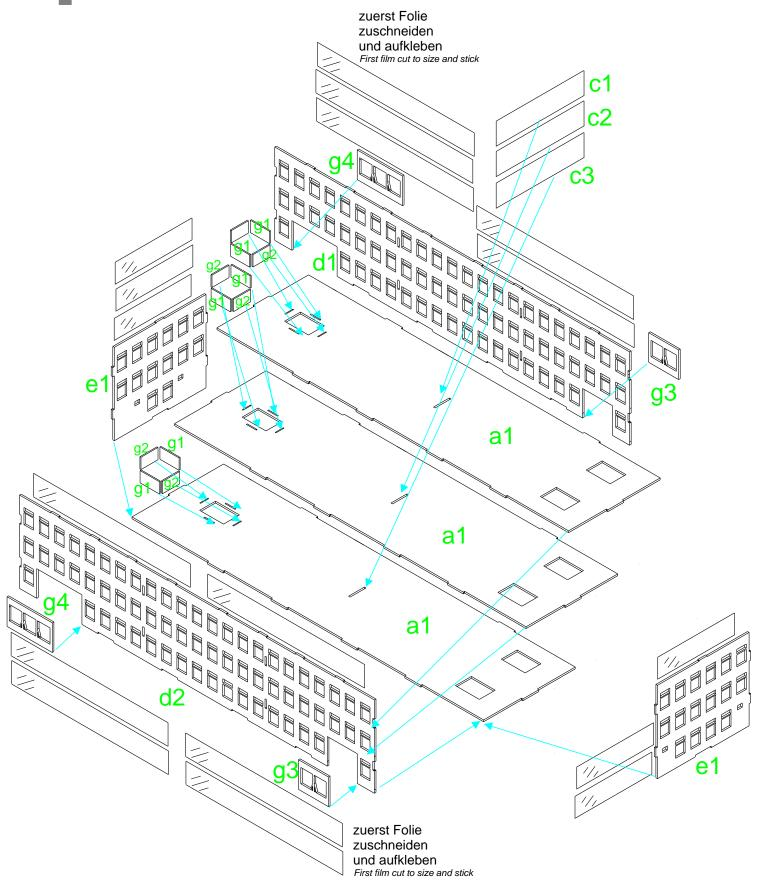
zuerst Giebelseiten, dann Längsseiten montieren first gable ends, then longitudinal sides mount
